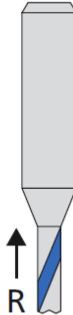
Standard Konturenfräser zum Fräsen von Außen- und Innenkonturen bei ES-, DS- und ML-Leiterplatten.
