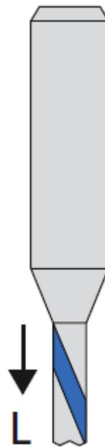
Standard Konturenfräser zum Fräsen von Außen- und Innenkonturen bei ES-, DS- und ML-Leiterplatten. Bei der „L“-Version ist ein Vorfräsen der Aufnahmeplatte notwendig. Vibrationsarmes Fräsen ohne Niederhalter möglich.
